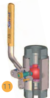
Bola Roscada Floating Cuerpo 3 piezas Modelo: [11]BFFSV Tamaño: 1/2" a 3" Presión: 3000 PSI Norma: ANSI B16.34
