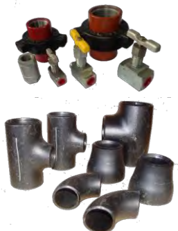
Accesorios tubería Tamaño: 1/2" a 48" Sch: 40 a 160 Material: Acero carbón
