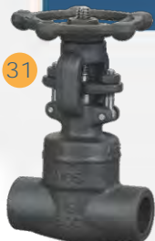
Compuerta Forjada Bonete Soldado Modelo: [31] GSSV Tamaño: 1/4" a 2" Clase: 800-2500 Norma: API 602
