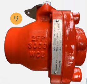
Bola Roscada Floating Cuerpo apernado Modelo: [9] BASV Tamaño: 2" a 4" Presión: 1.000-5.000 PSI Norma: ANSI B16.34
