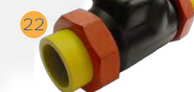
Cheque Swing doble unión Modelo: [21]CSVDU/ [22]CSV502 Tamaño: 2" a 3" Presión: 1.000-3.000 PSI Norma: ANSI B16.34
