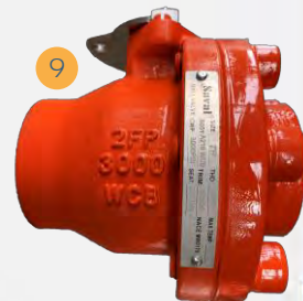
Bola Roscada Floating Cuerpo apernado Modelo: [9] BASV Tamaño: 2" a 4" Presión: 1.000-5.000 PSI Norma: ANSI B16.34
