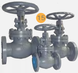
Globo fundición Modelo: [15] HASV Tamaño: 2" a 24" Clase: 150-2500 Norma: BS 1873
