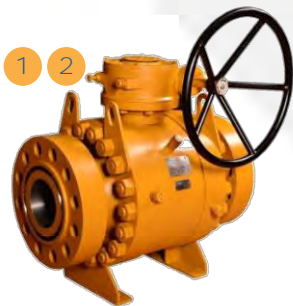
Bola Trunnion Forjada Modelo: [1]BSV/[2]BXS Tamaño: 2" a 48" Clase: 150-1500 Norma: API 6D
