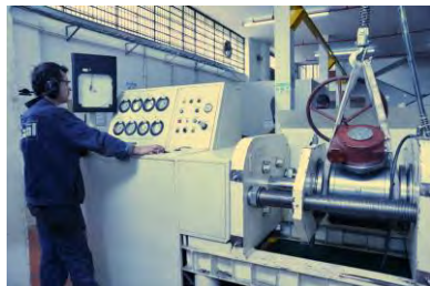
Servicio de Pruebas Hidrostáticas para válvulas Tamaño: 2" a 36" Clase: 150 – 2500 PSI Norma: API 6D y/o API 598
