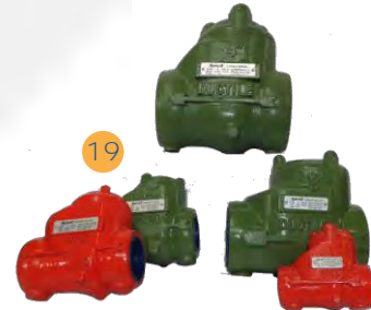
Cheque Swing Roscado Modelo: [19] CTSV Tamaño: 1" a 4" Presión: 2.000-5.000 PSI Norma: ANSI B16.34
